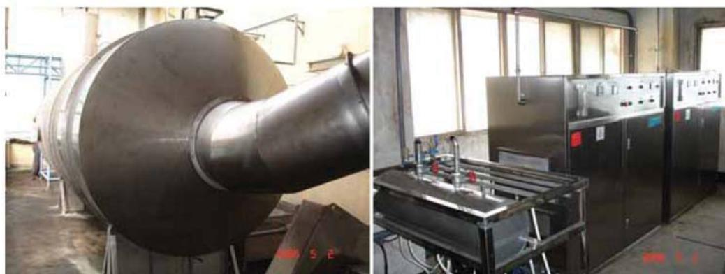
飼料乾燥排氣之臭氧接觸除臭系統：柱塞流反應器(左圖)、80 g/hr 臭氧產生器二部(右圖右)、臭氧緩衝桶(右圖左鋼架內)
