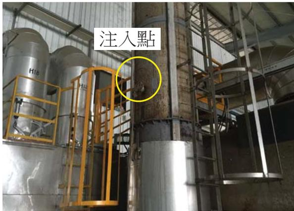
100公升水桶中先裝75公升水,再加入1.5公升工業用漂白水(12%有效氯)混勻後,再加入洗廁用鹽酸300mL混勻
