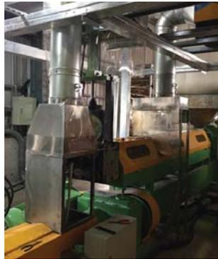
熱熔排氣口、熔膠出口集氣罩
